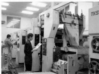
1時間に3万部を印刷する新聞専用の印刷機（回転機）です。
